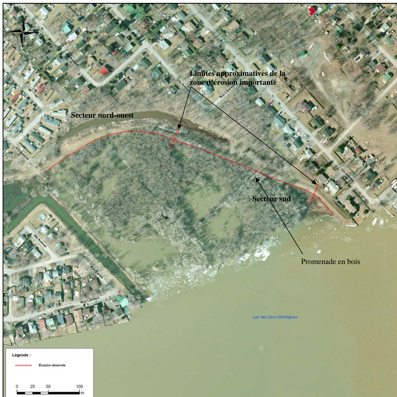
Figure 3 : Limites approximatives de l'érosion observée à la digue de Sainte-Marthe-sur-le-Lac
